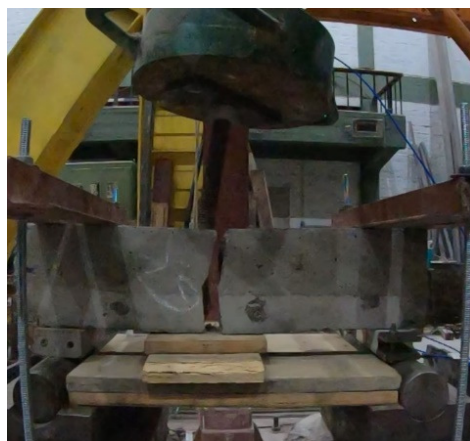
Figura 5: Viga sin refuerzo colapsada.
