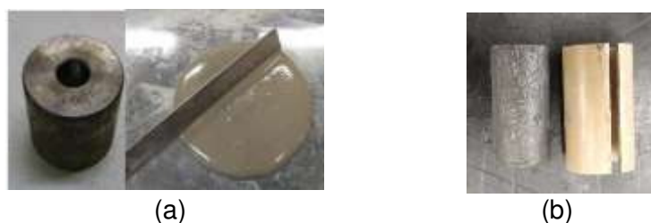
Figura 3: a) mini-cono de Kantró para evaluar la consistencia de la pasta de cemento y b) especímenes cilíndricos.
