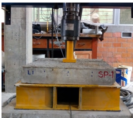
Figura 2: Ensayo de panel de sección cuadrada, EN 14488-5.
