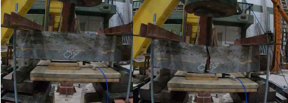
Figura 6: Viga con refuerzo de 60 \text{ kg/m}^3 en el primer y segundo impacto.
