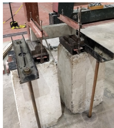
Figura 1: Sistema de Apoyos.
