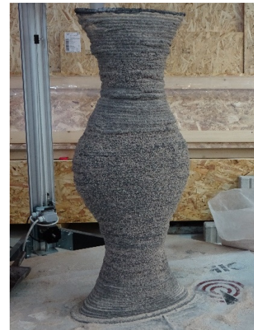
Figura 6: Izquierda: Resistencia mecánica de los morteros con los materiales seleccionados. Derecha: Objeto impreso con mortero de geopolímero GL.
