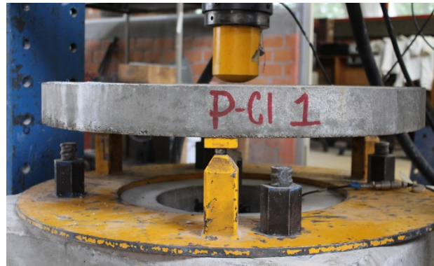
Figura 5: Ensayo de panel de sección circular, ASTM C1550.
