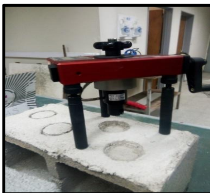
Figura 4: Equipo Pull off y bloque.
