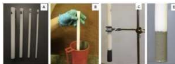
Figura 2: Metodología para evaluar EIP: a) Varillas de diferentes tamaños, b) inmersión de la varilla en pasta, c) y d) medición de la altura del revestimiento.
