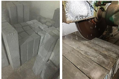
Figura 2: Curado en cámara húmeda (izq.) y entallado (der.) de las probetas.
