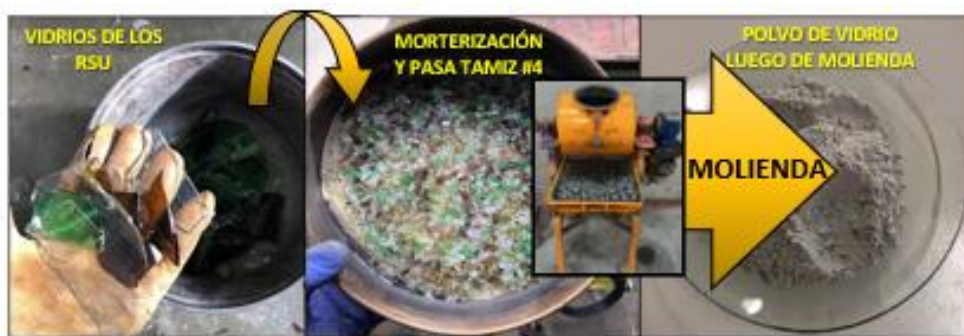
Figura 1: Proceso de transformación del vidrio, de botella a polvo.
