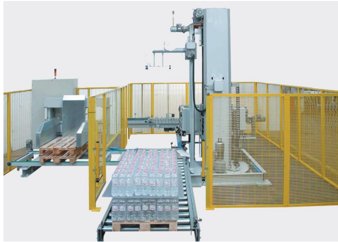
Ilustración 100- Estación de palletizado de línea
