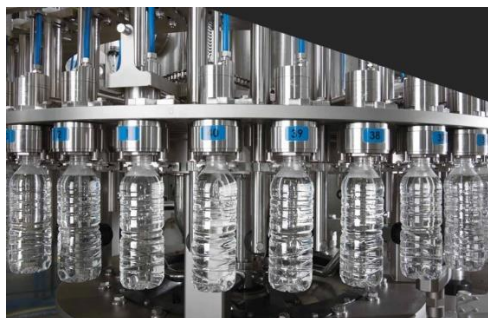
Ilustración 96- Estación de llenado
