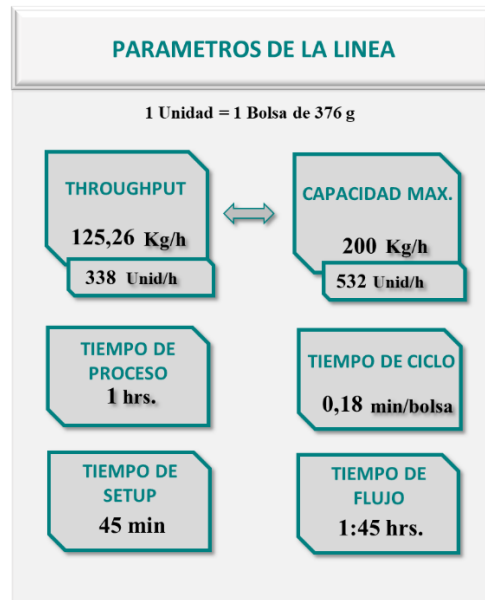
Ilustración 74: Parámetros de la Línea
