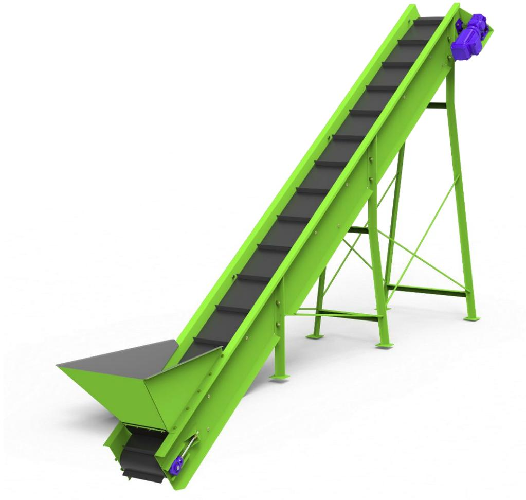
*Fig. MC - 43: Cinta transportadora (Fuente: Propia)*
