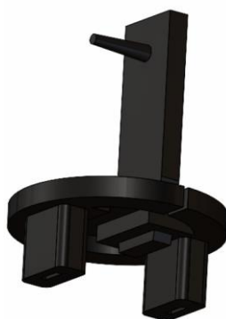
Figura 3.2.37 – Soporte de sensor de humedad
