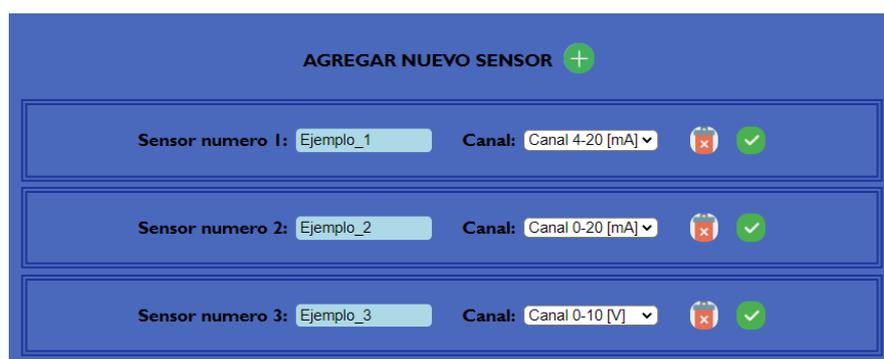
Figura 21 – “HMI: designación de sensores y canales en modo 1”
