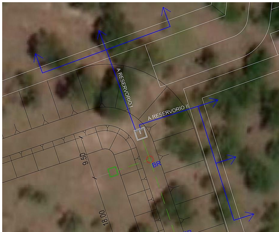
Figura 10.22 | Plano de implantación cámara distribuidora.
