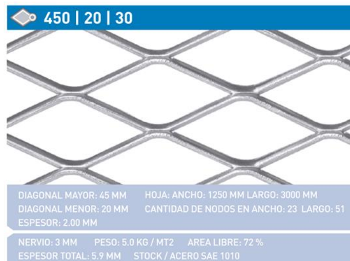
Figura 10.37|. Especificaciones técnicas metal desplegado
