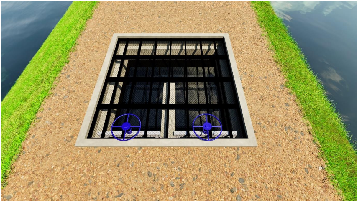
Figura Anexo: A-1.6: Cámara repartidora.
