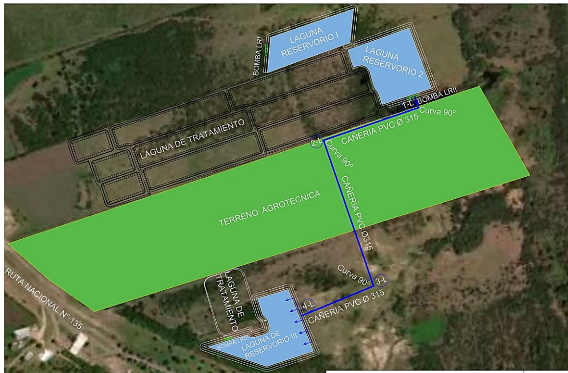
Figura 10.53 | Tendido de cañerías para conexión entre reservorio 2 y 3.
