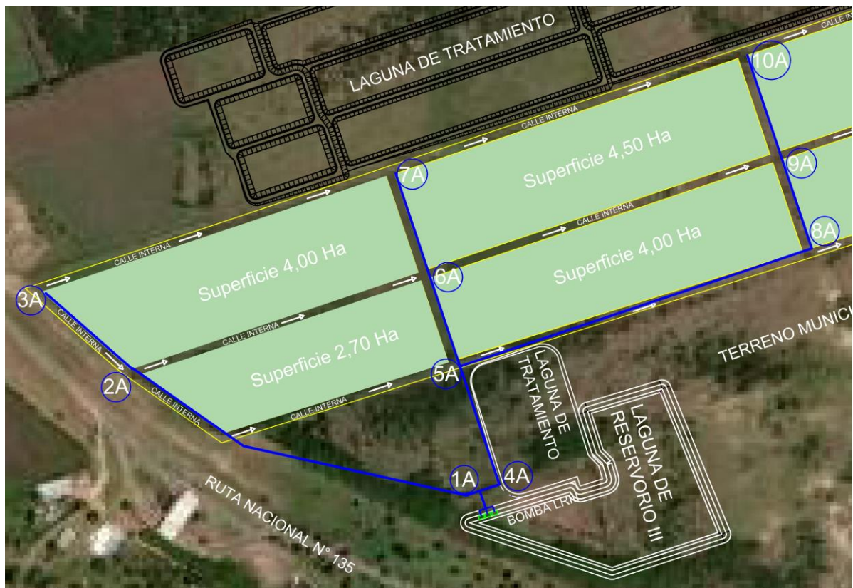
Figura 10.54 | Tendido de cañerías terreno escuela agrotécnica
