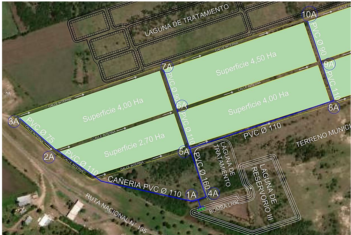
Figura 10.65 | Plano de cañerías terreno escuela agrotecnica
