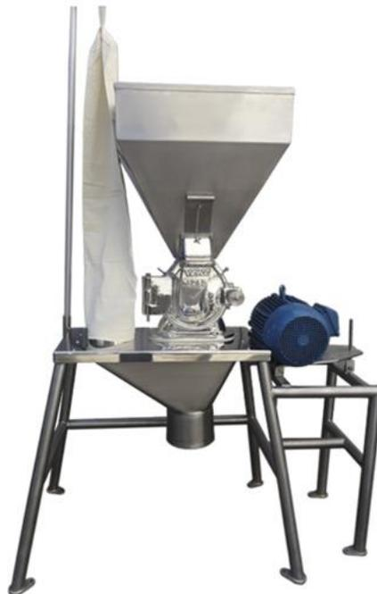
Figura 3.2: Molino pulverizador
