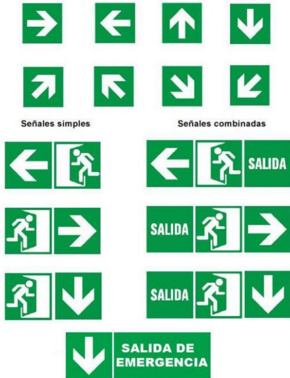
Figura 12.5: Señales de evacuación.
