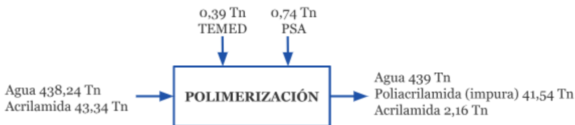
Figura 5.6: Diagrama de entradas y salidas para la etapa de polimerización.
