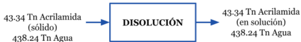
Figura 5.7: Diagrama de entradas y salidas para la etapa de disolución.
