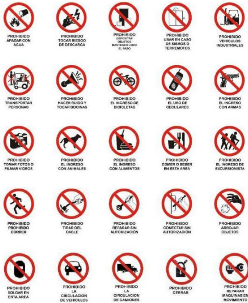
Figura 12.1: Señales de prohibición.
