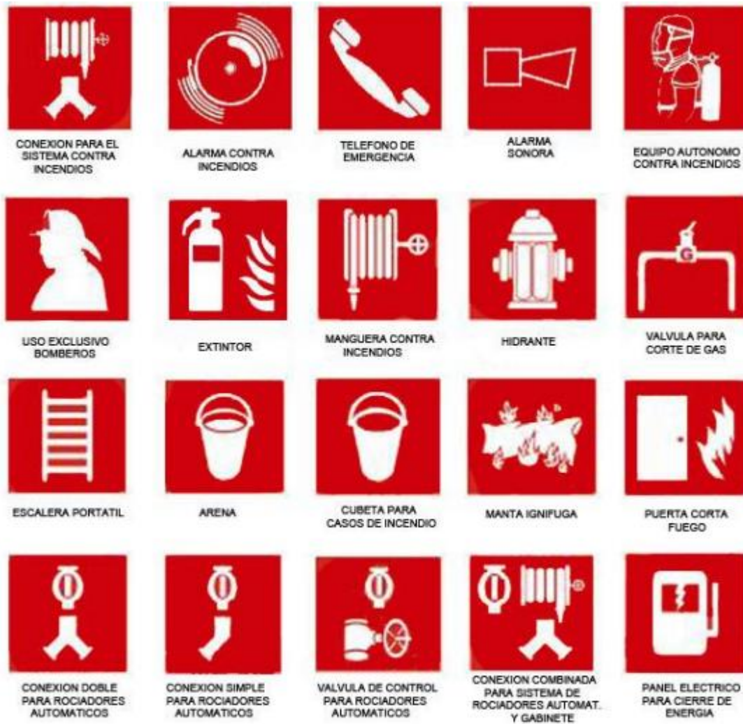
Figura 12.6: Señales de protección contra incendios.
