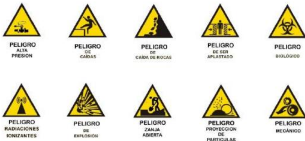
Figura 12.3: Señales de advertencia.
