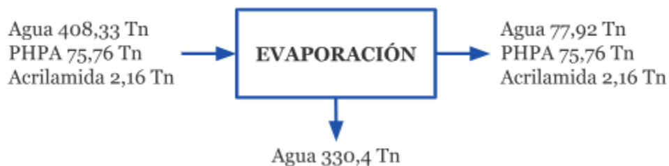
Figura 5.3: Diagrama de entradas y salidas para la etapa de evaporación.
