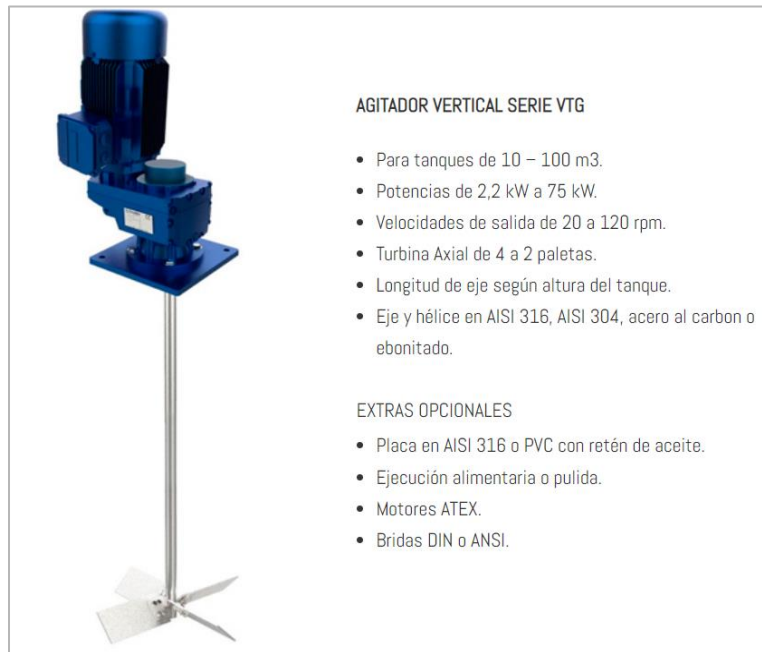
Figura 7.5: Características del agitador.
