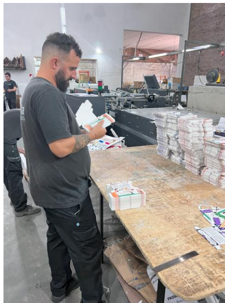
Ilustración 28. Preparación de estuches para pegado
