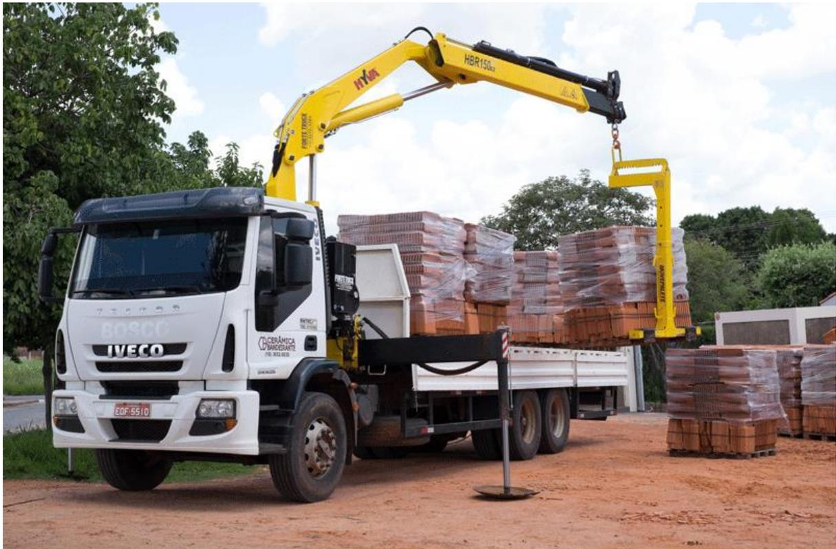
*Ilustración 27: Camión con grúa hidráulica*
