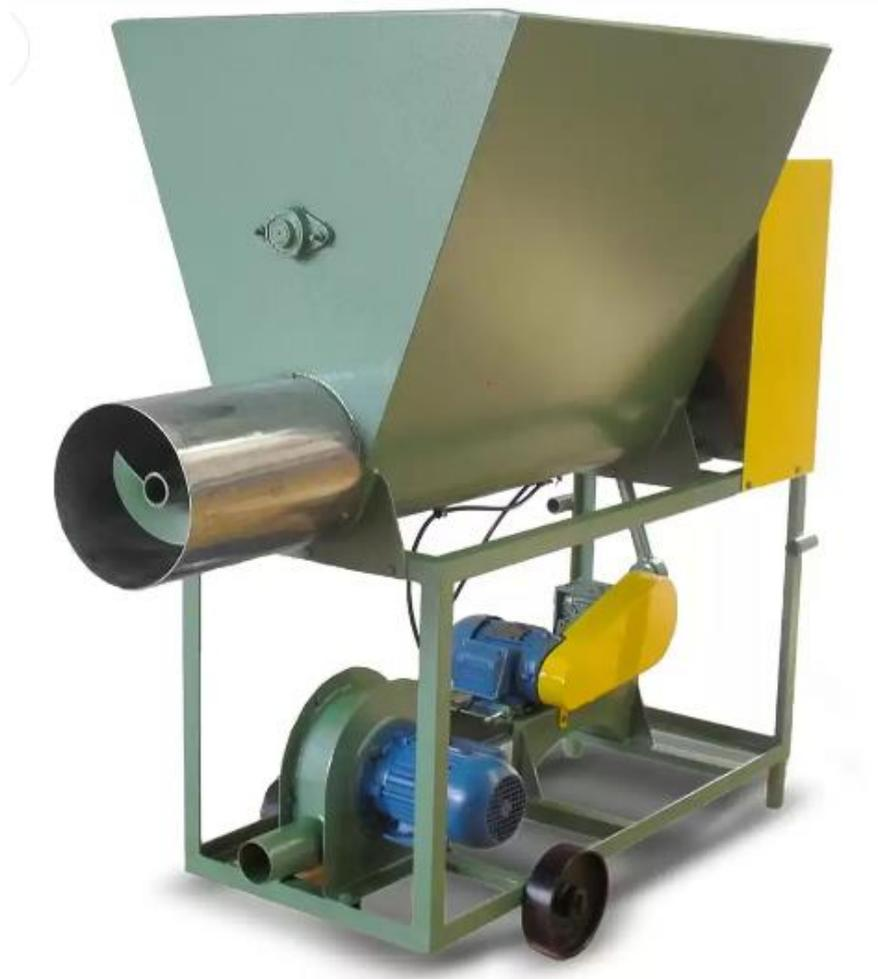
*Ilustración 40: Modelo de tolva de alimentación de aserrín empleada en la fábrica.*
