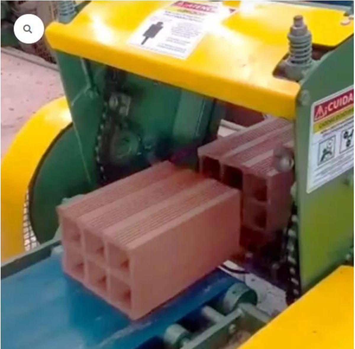
*Ilustración 34: Corte a medida de los ladrillos con la cortadora*
