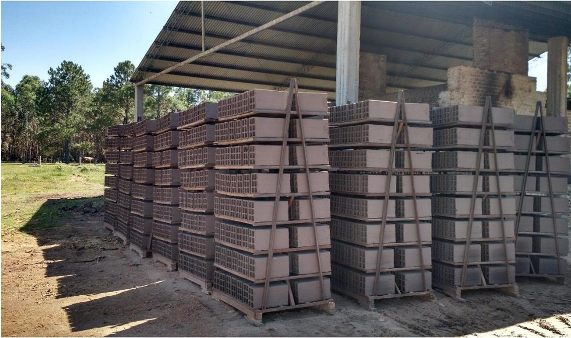
*Ilustración 35: Estanterías metálicas para el transporte de ladrillos en proceso de elaboración en el proceso actual*
