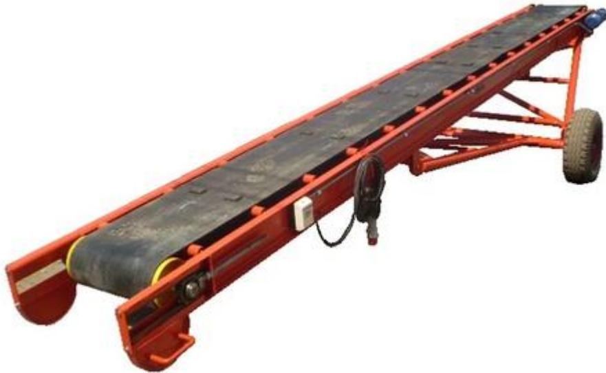
*Ilustración 43: Cinta transportadora para carga y descarga del horno*
