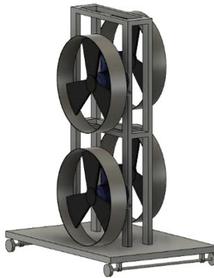
*Ilustración 37: Carro de ventiladores móviles de recirculación de aire en el secadero*
