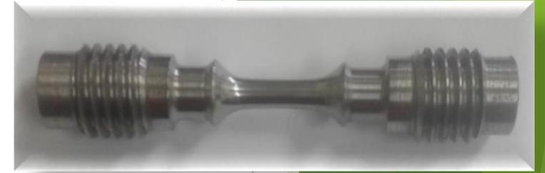
► Se le incorporó hidrógeno mediante la técnica de carga gaseosa, en un reactor elaborado para tal fin.
