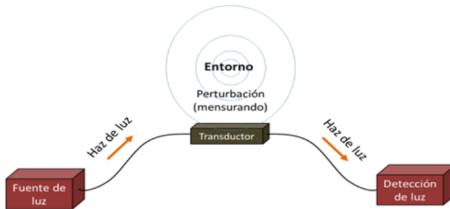
FIGURA 2 Esquema general de un sistema de interrogación de un OFS.
