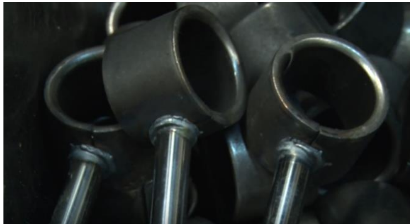
Ilustración 11 Vástago soldado al anclaje.
