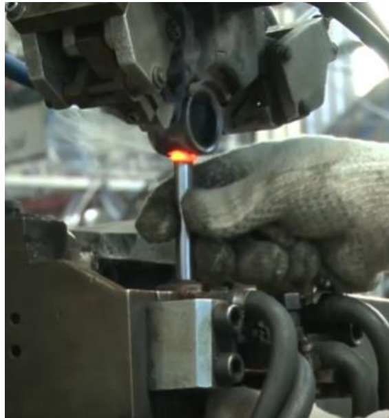
Ilustración 10 Proceso de soldadura del conjunto vástago-anclaje.
