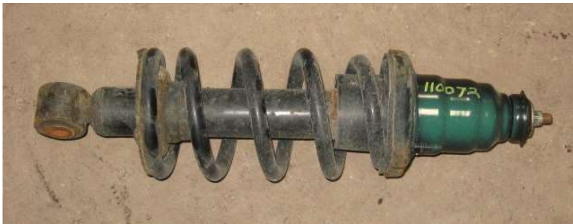
Ilustración 2 Amortiguador corroído
