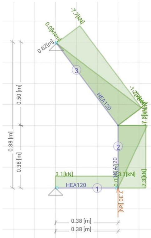
Ilustración 8 Diagrama de esfuerzos suspensión delantera.
