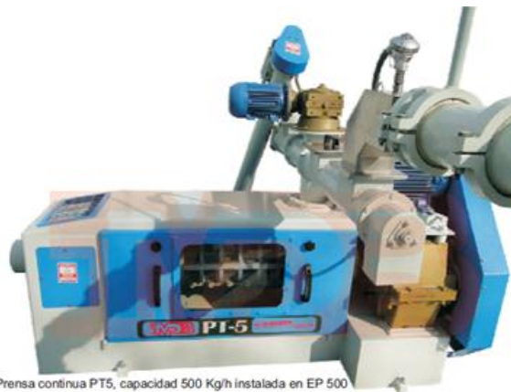
* Prensa continua PT5, capacidad 500 Kg/h instalada en EP 500
