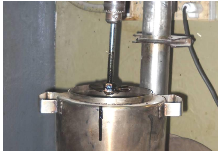
Figura 4. Colocación del agitador al centro del recipiente
