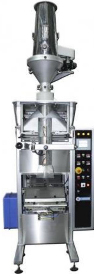
Figura 8.36: Envasadora del producto final, con dosificador incluido
