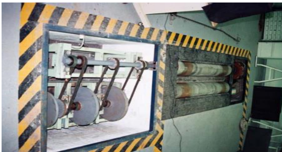
Imagen 6: podemos ver un banco de dos rodillos y el acoplamiento a los discos inerciales. Vemos que se usan correas, aunque ello no se recomienda porque puede llegar a patinar la correa en la polea generando inconvenientes en la medición.
