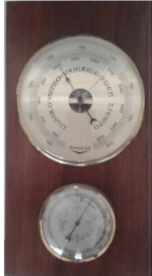
Imagen 39: En la parte superior vemos un medidor de presión ( para este caso está indicando 1010 hPa) y el instrumento de abajo indica un 59% de humedad relativa.
