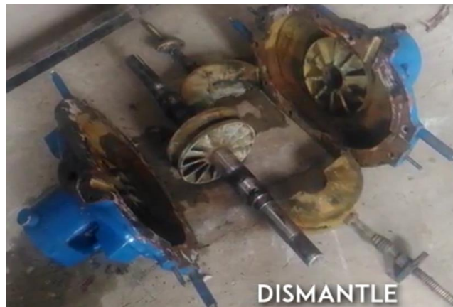
Imagen 14: despiece de dinamómetro hidráulico 50 hp @1500 rpm. En el centro se encuentra el rotor y adosado a la estructura se encuentran los alabes estáticos que recibirán el choque de las partículas.
