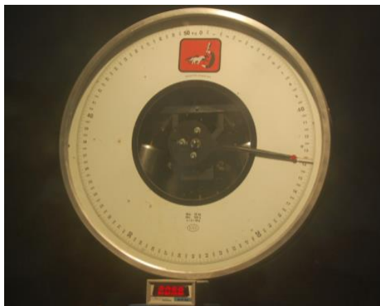
Imagen 38: balanza marcando el esfuerzo que le transmite el dinamómetro, en la vase se puede ver el indicador del tacómetro.
