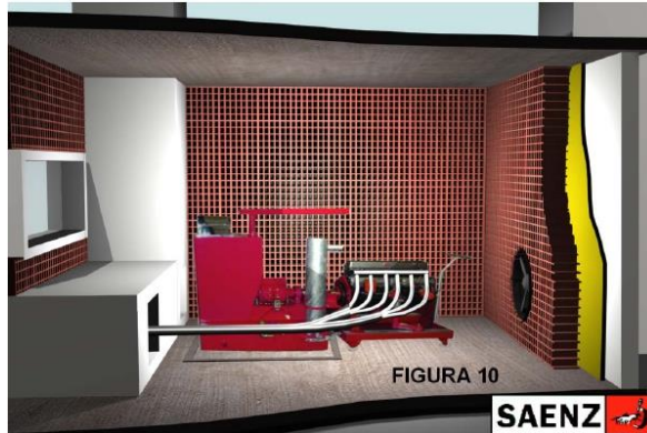
Imagen 16: Esquema que representa el sistema de evacuación de gases de combustión.
