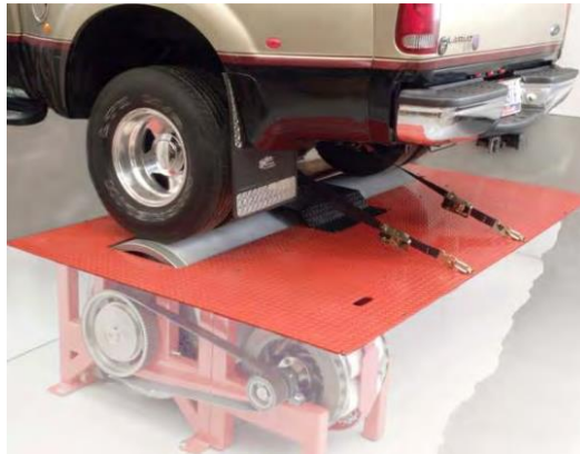
Imagen 5: vista esquemática de un banco de rodillos con dinamómetro de corrientes de Foucault, ensayando una pick-up a propulsión.
