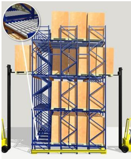
Ilustración 29 - Rack dinámico de almacenamiento de pallets
