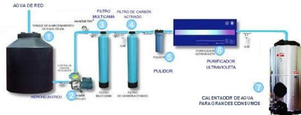
Ilustración 33 - Sistema de purificación.
