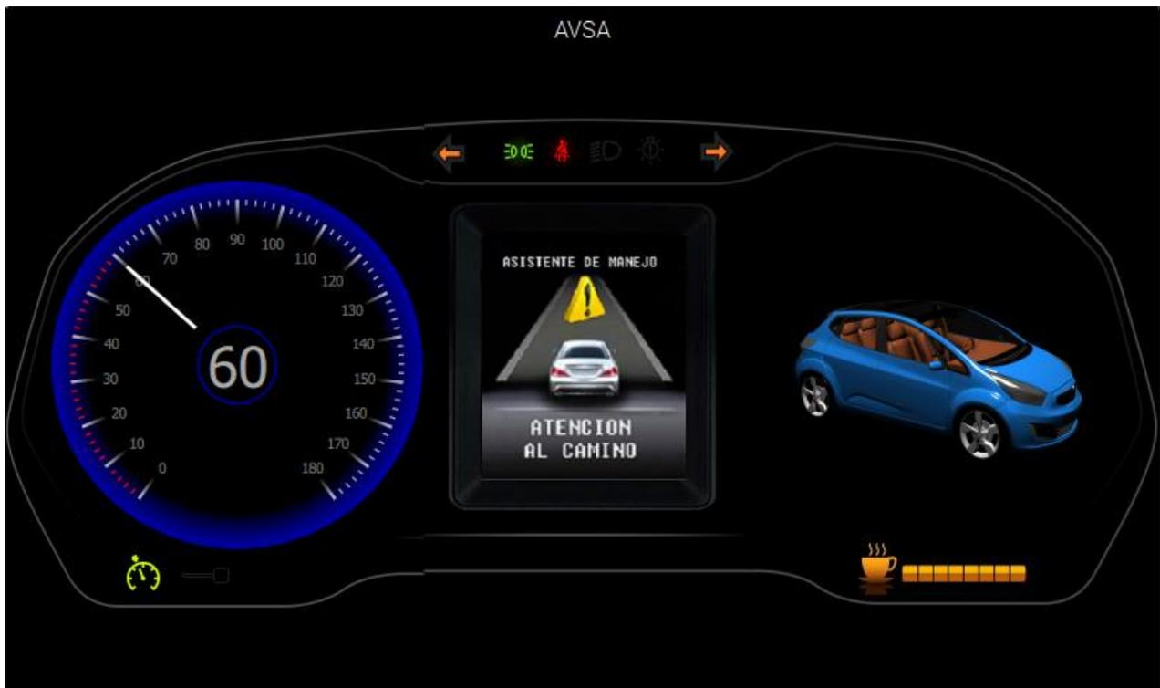
Fig. 33 Componentes de la interfaz. Indicador de estado en atención al camino
