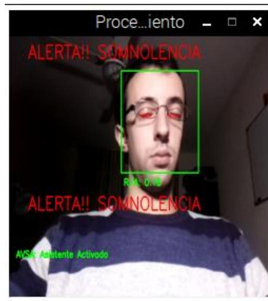
Fig. 43 Resultado final. Detección de somnolencia utilizando lentes recetados
