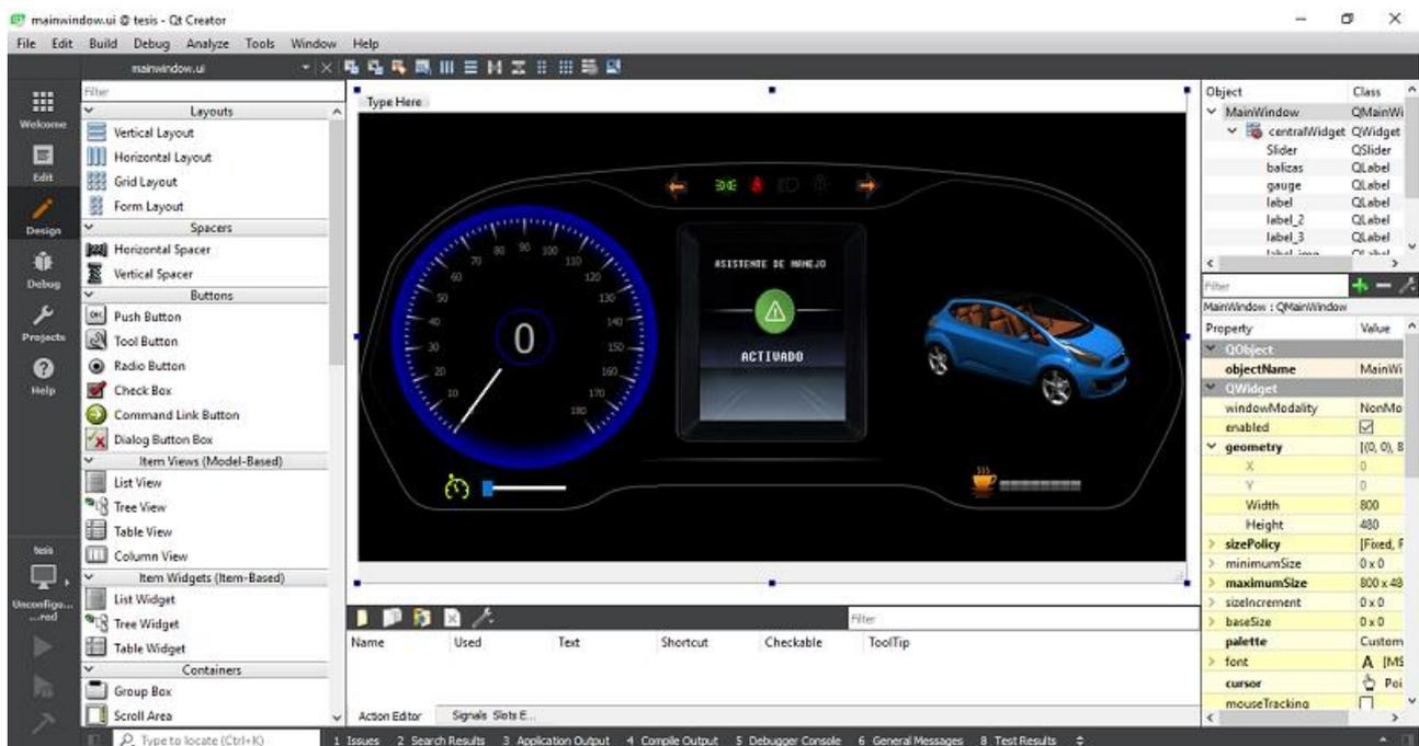
Fig. 29 Interfaz gráfica. Diseño en herramienta Qt Creator
