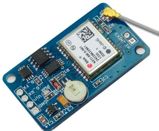
Fig. 16 GPS del equipo. Módulo de GPS para Raspberry
