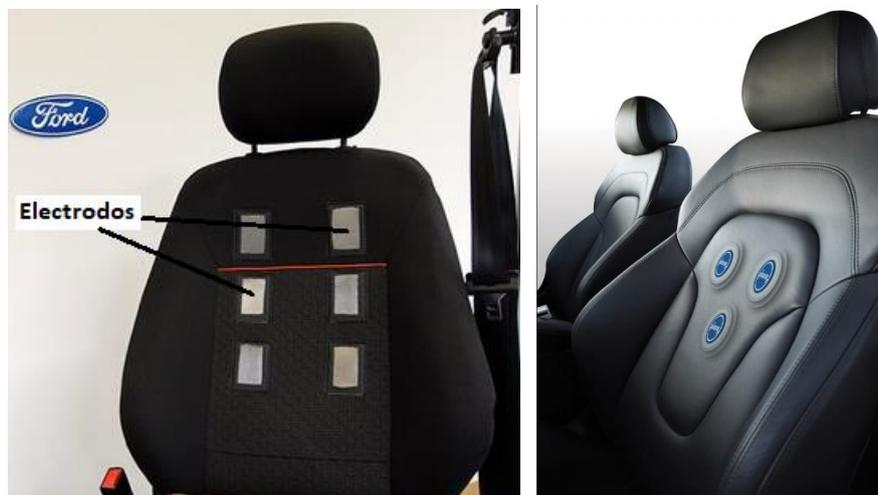
Fig. 4 Parametrización del manejo – Ejemplos de asientos para el análisis de electrocardiograma
