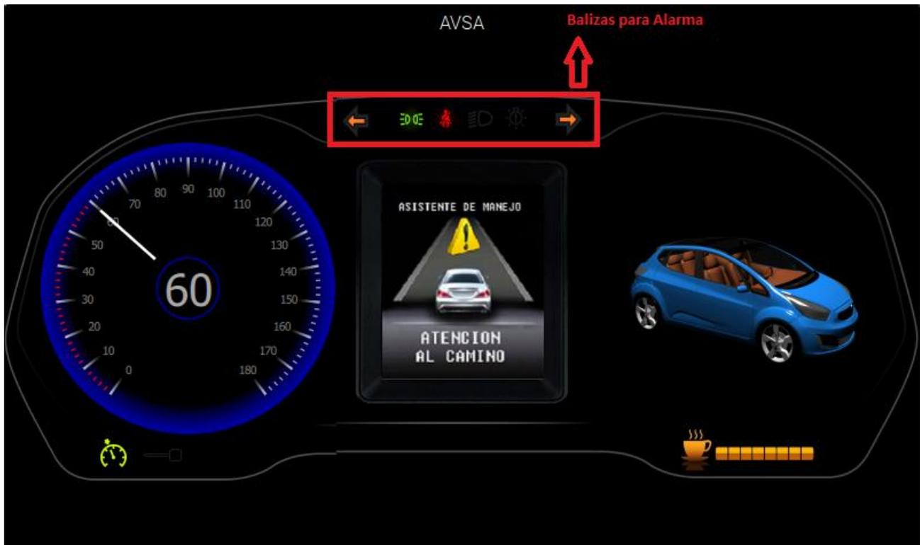
*Fig. 37 Componentes en la interfaz. Indicador intermitente*
