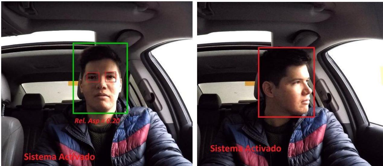
*Fig. 6 Fotograma. Activación y desactivación del sistema según la velocidad del vehículo*
