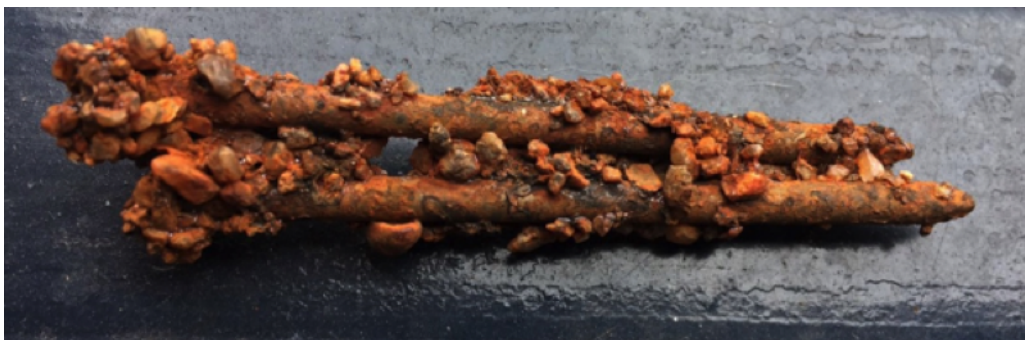
Figura 4 Complejo adsorbente formado entre la arena y los clavos, responsable de la eliminación efectiva del arsénico del agua surgente de la zona de San José de Boquerón.
