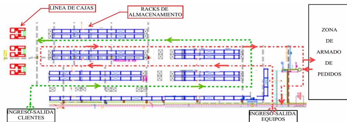
Figura 2 Diagrama simplificado del movimiento interno del almacén. Elaboración propia.
