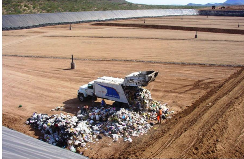
Figura N° 7: Fotografía etapa de operación de un relleno sanitario. Extraída del diario Valle del Mayo de México, fecha 7 abril de 2018.
