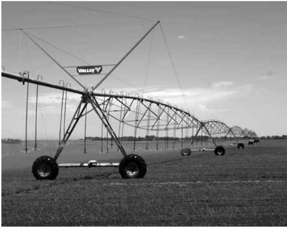
**Figura 10: Sistema de riego por aspersión con pivote central en cultivo de cebolla.**
