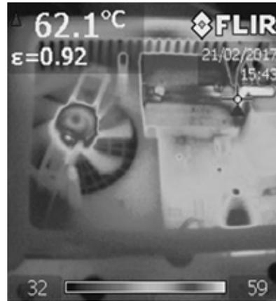
Figura 9: Imagen de la cámara térmica, durante el ensayo de conductividad térmica.
