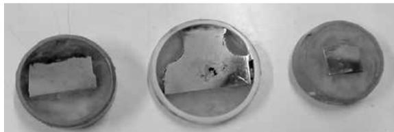
**Figura 3: Probetas preparadas para observación.**
