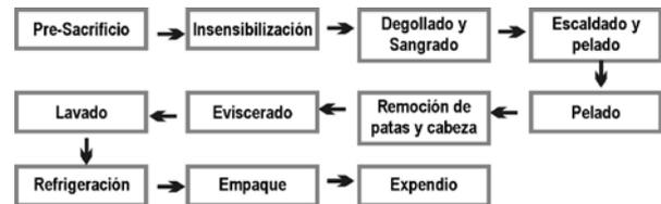
Figura 3 : Diagrama de bloques del proceso de faena de pollos.
