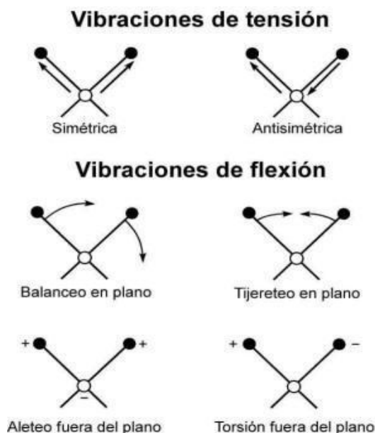
Figura 3 – Vibraciones de tensión y flexión de los enlaces Técnica FTIR.
