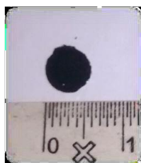
Figura 10 - Electrodos, discos de 6 mm de diámetro.
