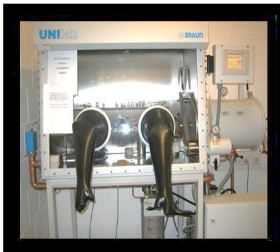
Figura 11 - Cámara de guantes de gas inerte.
