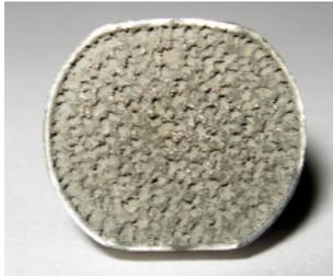
**Fig. 2.** Fotografía de cara de probeta ensayada mediante método de ultrasonido, se observan cavidades de conformación irregular uniformemente distribuidas, borde sin deterioro.
