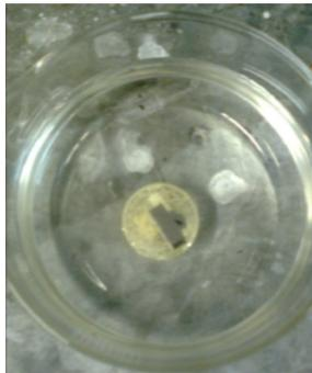
**Fig. 3.** Corte transversal de la probeta sometida a cavitación, luego de ser previamente pulida a espejo e incluida en bloque de resina, en la fotografía esta probeta se encuentra en cubeta donde se le hizo el baño electrolítico. Laboratorio Metalurgia UTNFM.
