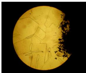
**Fig. 4.** Metalografía de borde en probeta ensayada a la cavitación mediante la técnica de ultrasonido. Laboratorio de Metalurgia de UTNFRM, aumento 100X, ataque en baño electrolítico de solución de ácido oxálico al 10%.
