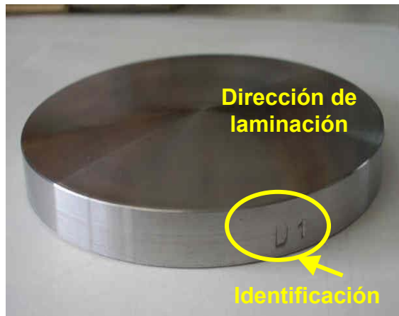
Figura 2. Fotografía de una probeta con la dirección de laminación y su identificación grabada en el canto.
