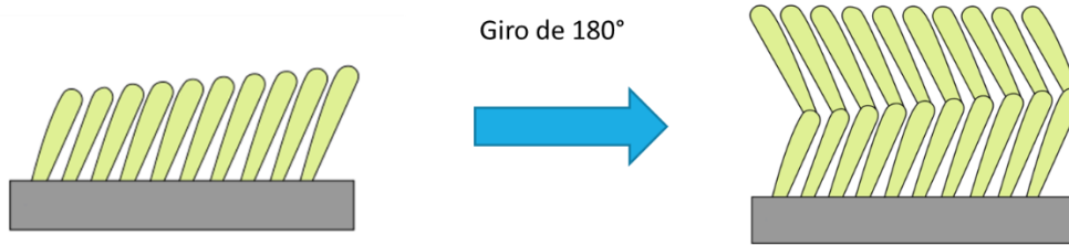
Figura 3.6: Ilustración de la deposición Chevron.
