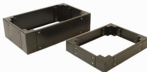
Diseñados para elevar los gabinetes sobre el nivel del piso. Facilitan el acceso a las entradas de cables. Permiten, quitando las tapas laterales, la elevación de los gabinetes mediante la utilización de auto elevadores y/o carretilla (Zorras) hidráulicas.
