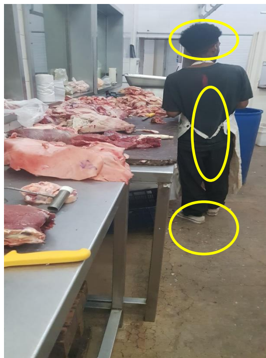
Ausencia de ropa de trabajo adecuada
