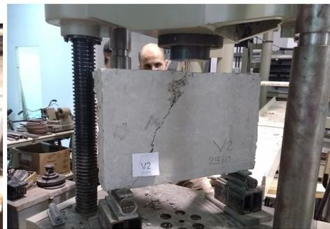
(b) Vigas de hormigón simple
