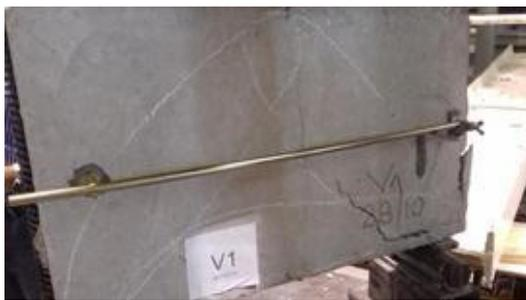
(a) Vigas de hormigón simple
