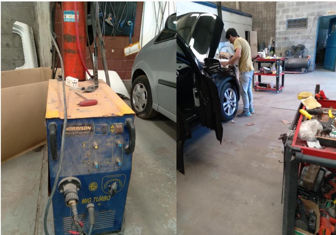
**Figura 15. Soldadora MIGMAG del taller sin epp**
