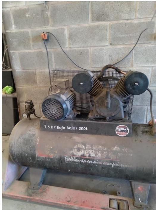
**Figura 17. Compresor de aire. 300lts**
