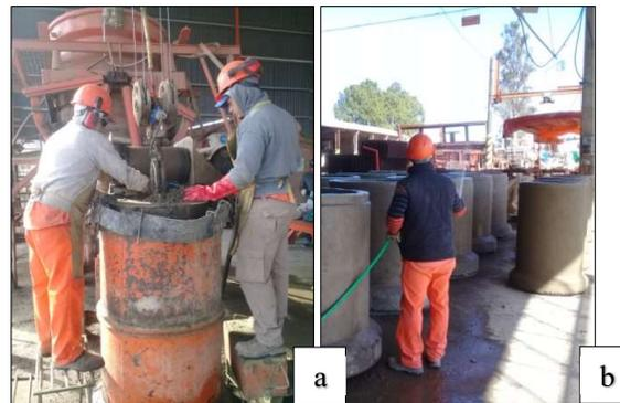
**Figura 2:** a) Moldeo; b) Curado.
