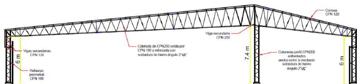
Figura MC-02. Características constructivas de la planta
