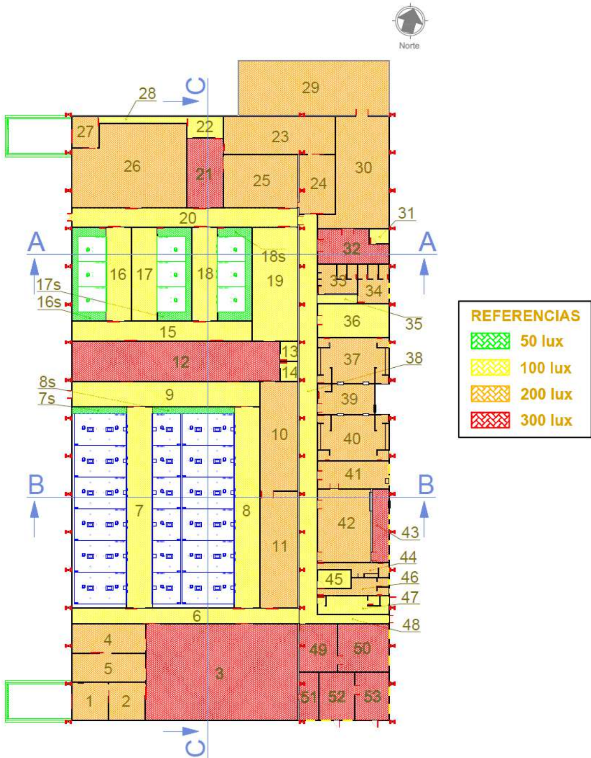
Figura IB-05. Niveles de iluminación.
