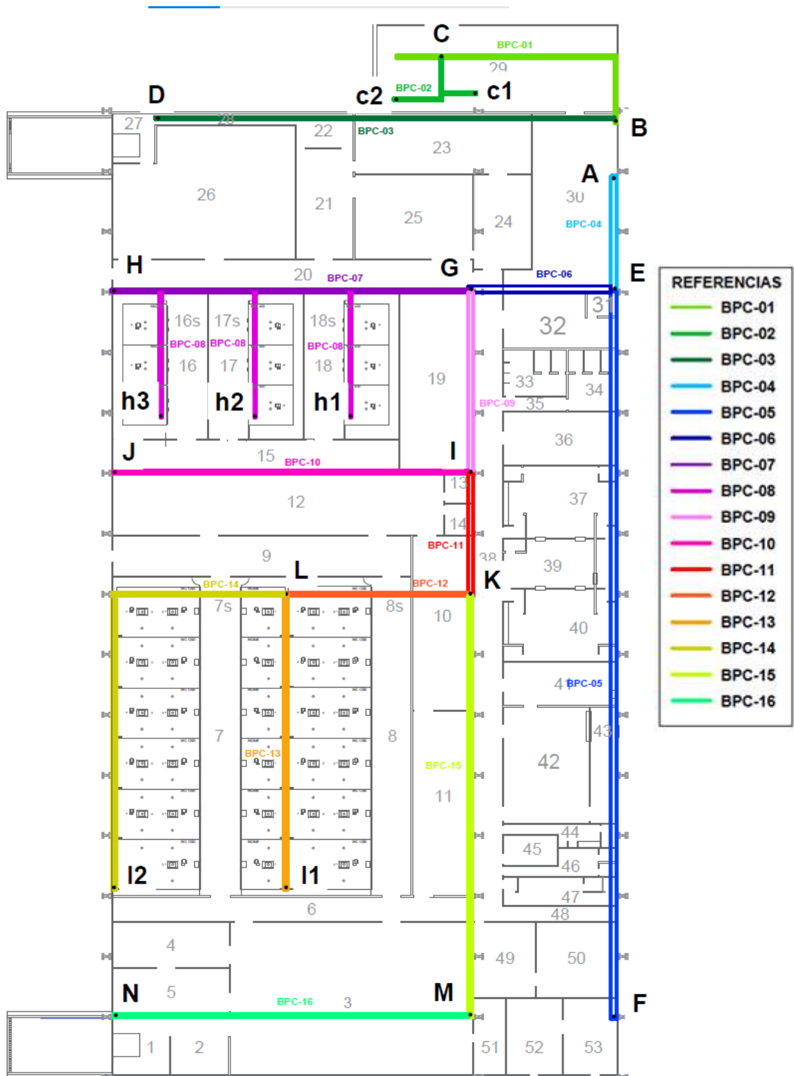
Figura MC-66. Tramos del tendido eléctrico
