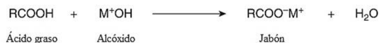
Figura 1.19. Reacciones de hidrólisis de triglicéridos y saponificación de los ácidos grasos libres resultantes. Adaptado de Verhé y col. 28
