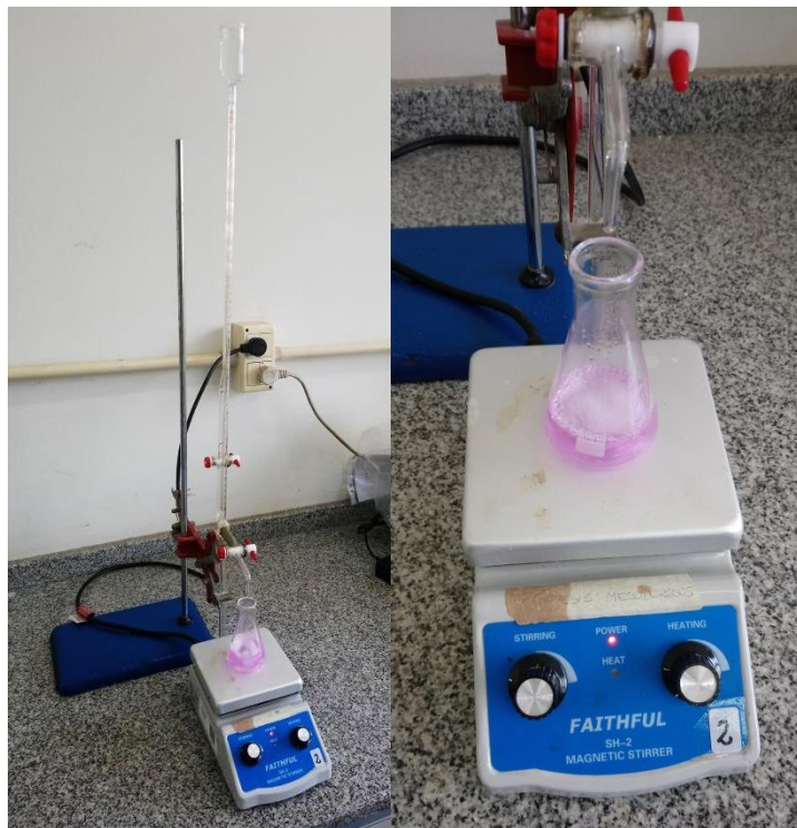
Figura 2.18. Sistema utilizado para determinar el índice de acidez de las distintas muestras.
