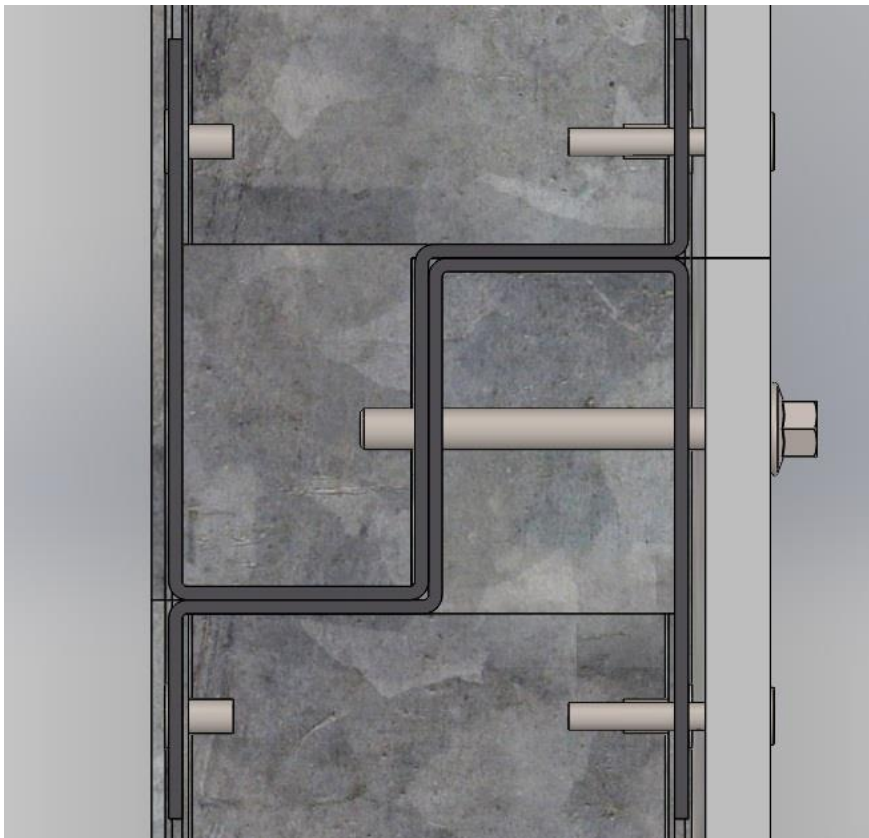
Figura 34. Detalle en corte de vinculación entre paneles.
