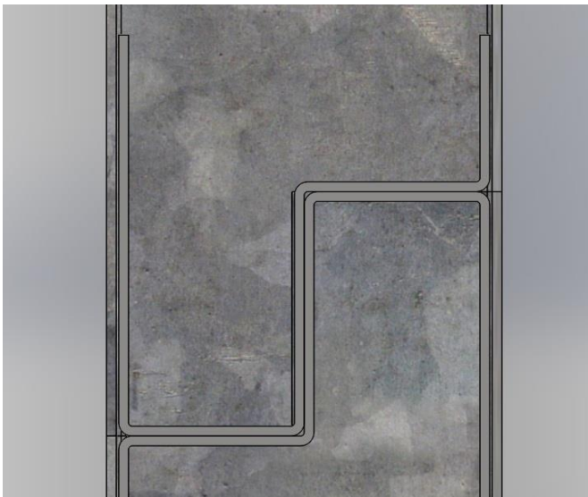
Figura 8. Apoyo entre perfiles parantes de paneles.
