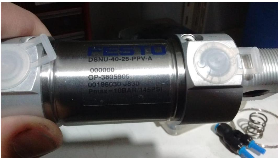
Figura 35. Cilindro neumático.
