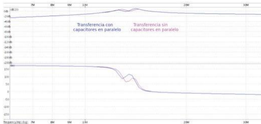
Fig. 7. Transferencia de tensión en el circuito resonante del PCD con capacitores en paralelo al circuito resonante del PICC y sin estos
