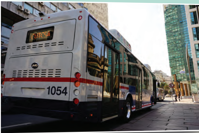
Los buses eléctricos son vehículos de fabricación china, marca BYD, modelo K9W, de 12,05 mts de largo, piso low entry, con 3 puertas y 31 pasajeros sentados.
