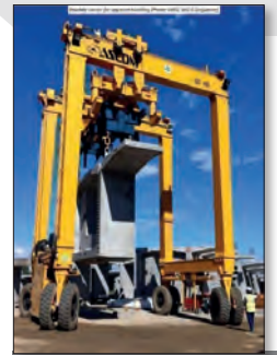
Figura 9C Equipos e instalaciones c) pórtico de movimientos internos.
