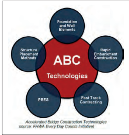
Figura 13 Componentes del sistema de construcción acelerada de puentes ABC: Accelerated Bridge Construction.
