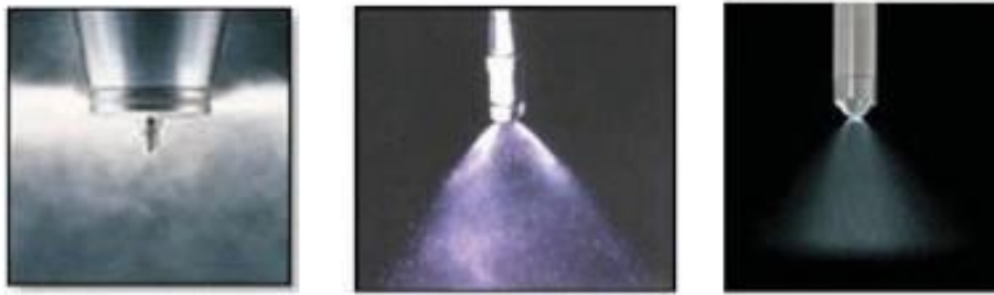
Fig. 3. Diferentes tipos de atomizadores: de izquierda a derecha: centrífugos, boquilla a presión y boquilla neumática
