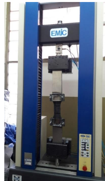
Figura 21: Muestra durante el ensayo de tracción.
