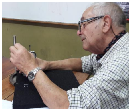
Figura 13: Medición de los espesores de una baldosa.
