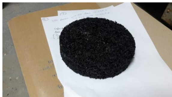
Figura 5: Probeta con problemas de fragüe.
