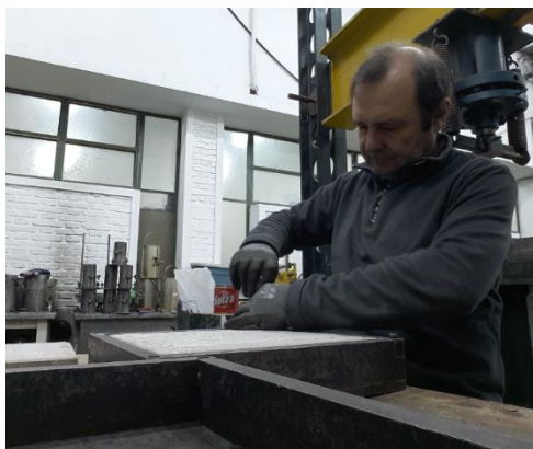
Figura 10: Desmolde luego del fragüe.
