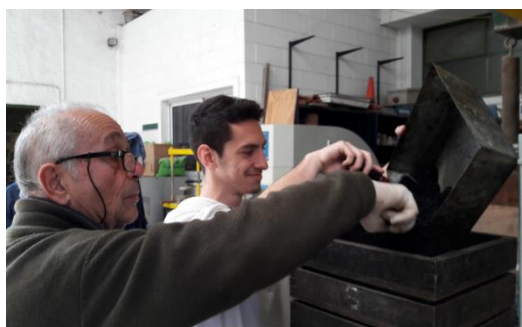
Figura 7: Llenado con mezcla de los moldes.
