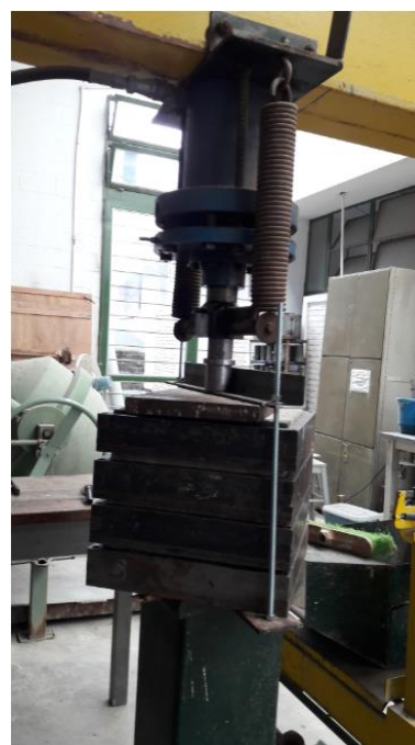
Figura 9: Colocación del sistema para mantener la presión.
