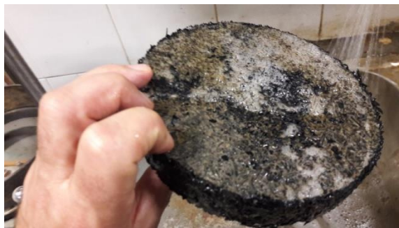
Figura 3: Alcohol polivinílico como desmoldante
