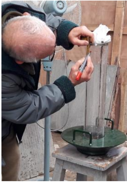
Figura 15: Preparación del permeámetro.
