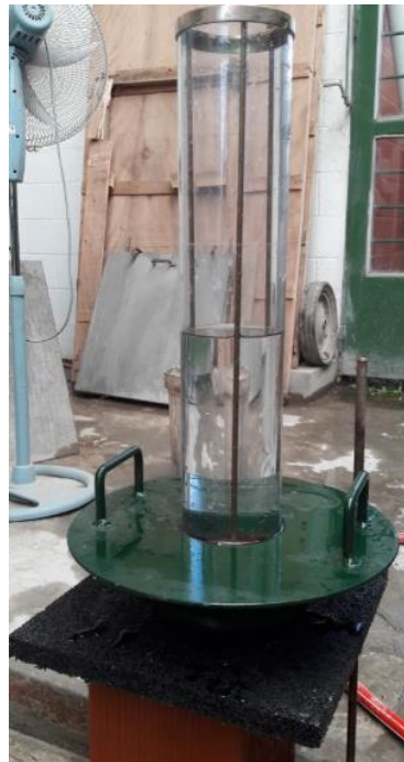
Figura 15: Preparación del permeámetro.
