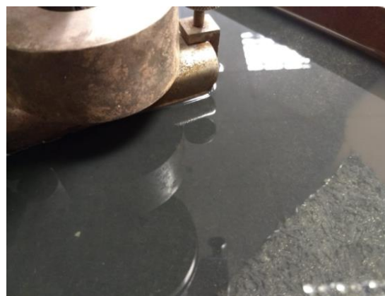
Figura 17: Detalle del paso del equipo sobre la baldosa durante el ensayo.
