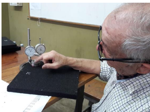
Figura 12: Preparación para la medición de los espesores.
