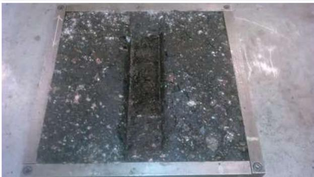
Figura 4. Probeta de WTT ensayada. Fuente: elaboración propia
