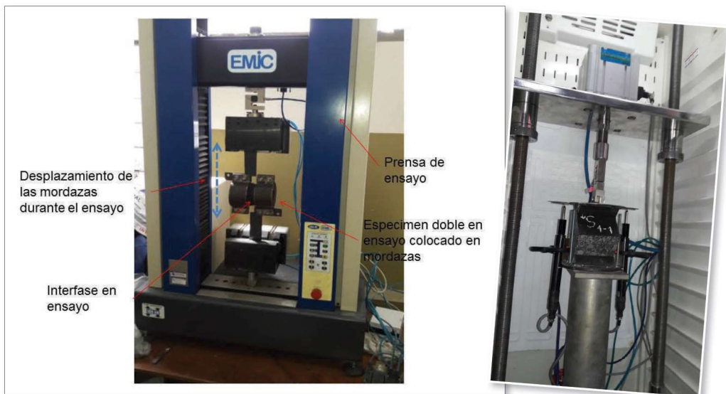
Ensayo estático (izq.) y dinámico (der.) empleados en el desarrollo de la Tesis.
