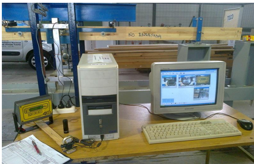
Figura 3: Equipamiento para captura por cámaras Web
