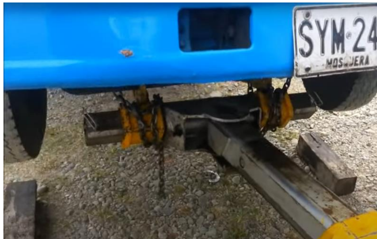
Figura 38: detalle de la fijación mediante cadenas.
