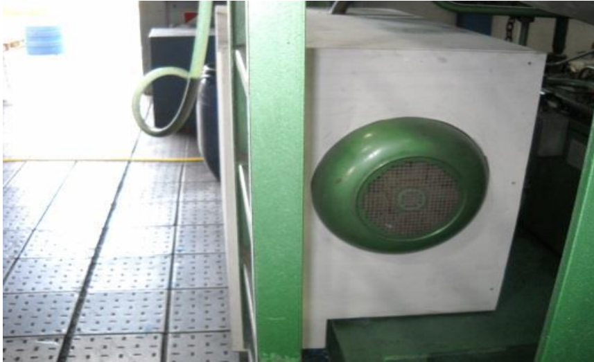
Figura 35- fuente propia. Caja acústica para reducción de ruidos.
