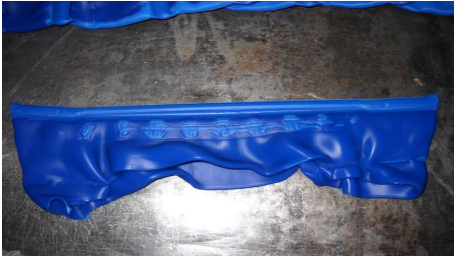
Figura 24- fuente propia. Colada sobrante (Scrap) destinada a molienda y reutilización
