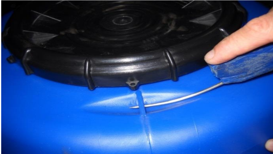
Figura 27- fuente propia. Perforado manual de inserto para precinto de seguridad
