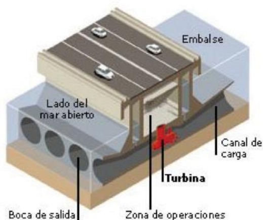
Fig. 1. Descriptivo de una central mareomotriz (catedu.es)
