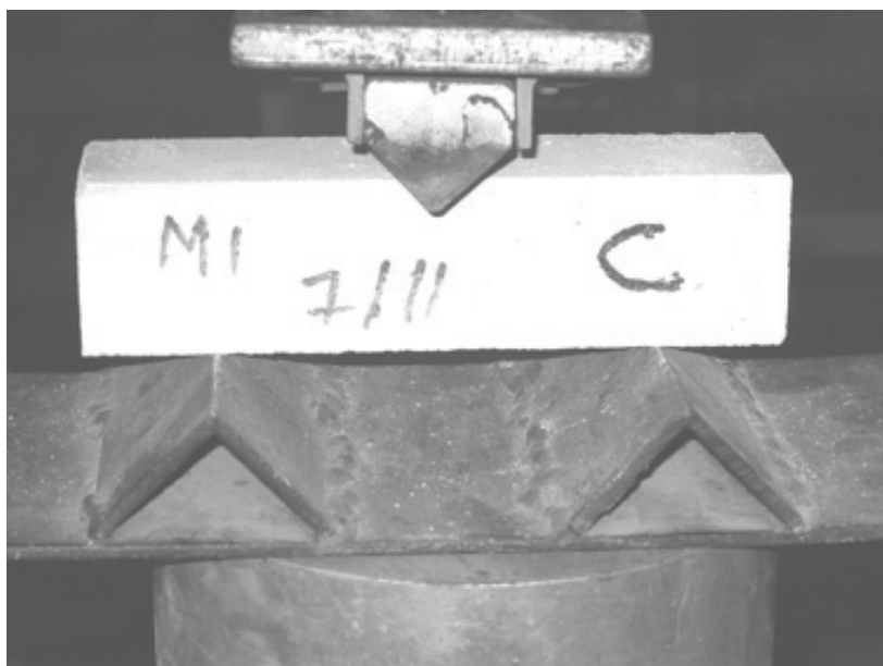
Imagen 2. Probeta con dispositivo para ensayo de flexión
