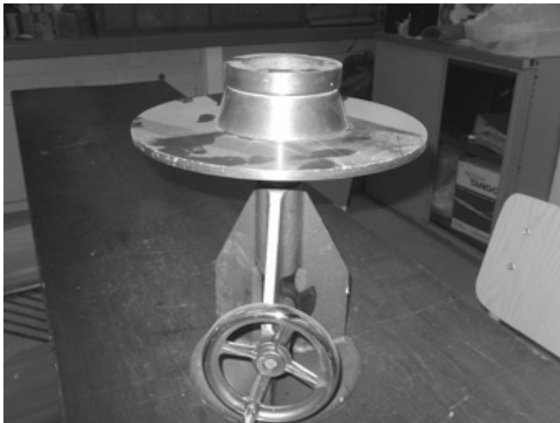
Imagen 1. Disco de asentamiento y molde para determinación de consistencia
