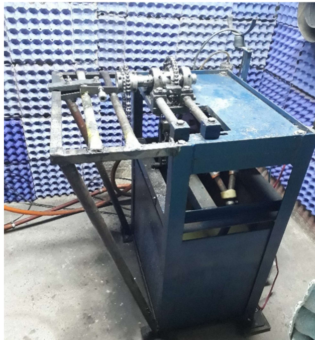
Figura 3 – Banco de ensayo con freno hidráulico
