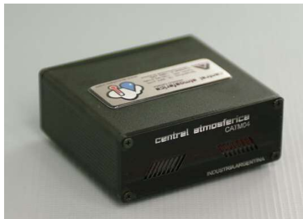
Central atmosférica. Conexión digital con sistema de adquisición de datos marca Accudyno.
