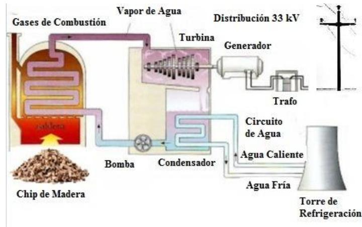
**Figura 2:** Esquema de Funcionamiento de una Central Térmica a base de Biomasa.
