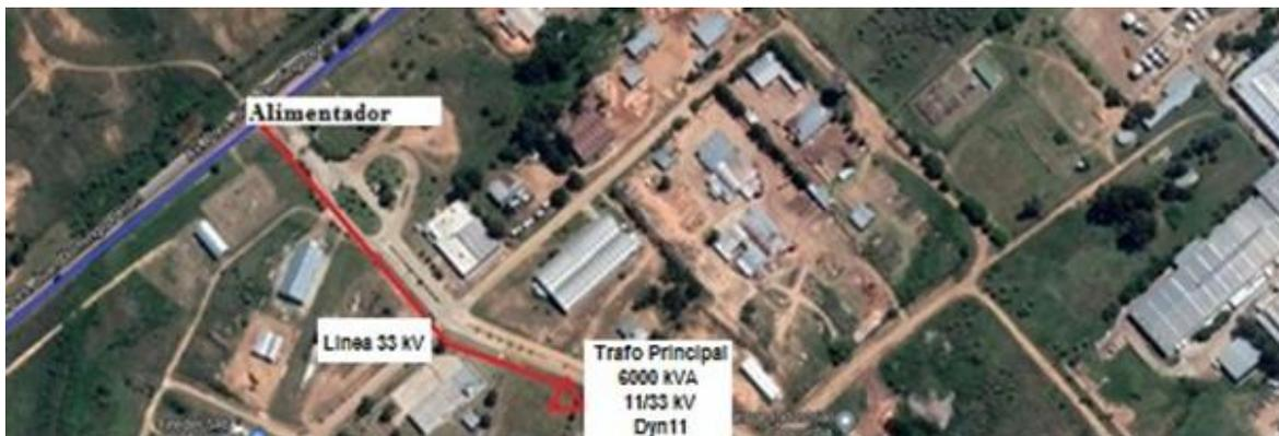
**Figura 41:** Vista satelital de la conexión con el Alimentador.
