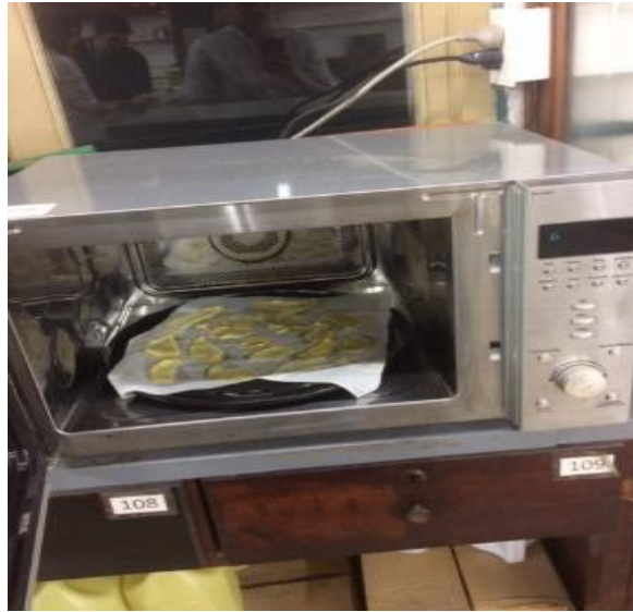
Figura 29. Equipo de secado combinado (microondas y convección con aire caliente). En su interior se puede observar la disposición de las rodajas de peras.
