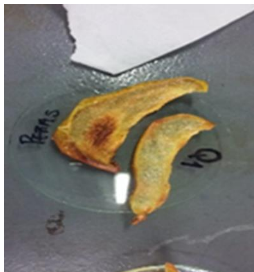
Figura 47. Fotos peras sometidas a un secado combinado (microondas a 400 W) durante 15 min pretratadas por deshidratación osmótica/impregnación sin lactato de calcio durante 1 hora.
